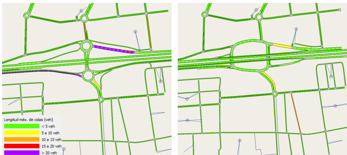
Figura 25: Comparación longitud máxima de colas estado Actual – Propuesta 2.2
