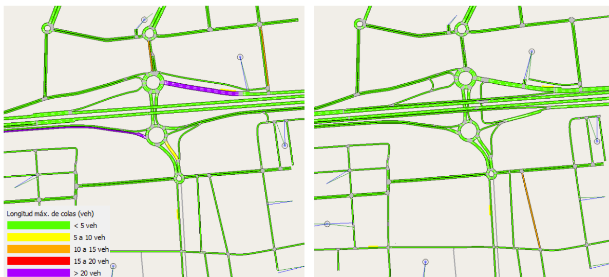
Figura 15: Comparación longitud máxima de colas estado Actual – Propuesta 1.2
