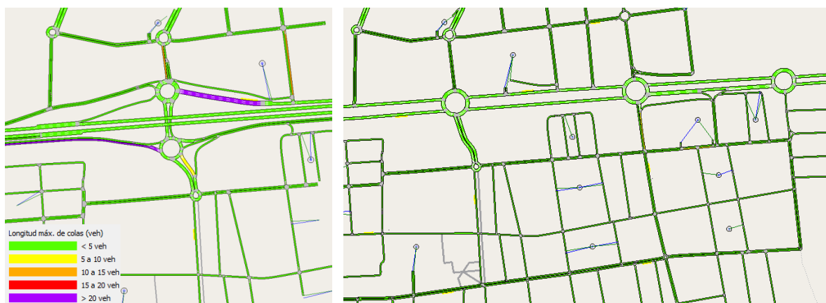
Figura 28: Comparación longitud máxima de colas estado Actual – Propuesta 4
