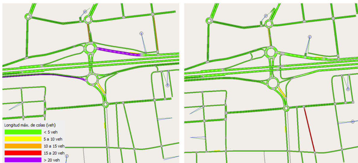
Figura 14: Comparación longitud máxima de colas estado Actual – Propuesta 1.1
